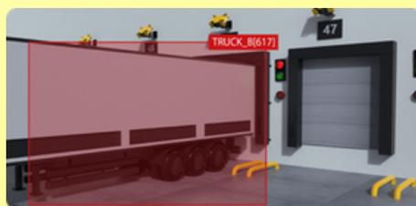
Quando o TRUE-AI deteta um veículo em movimento na doca, comunica com o calço elétrico e hidráulico de bloqueio e envia alertas audiovisuais.
