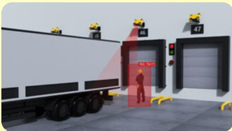
Quando um camião se aproxima do cais de carga, o TRUE-AI deteta o veículo e monitoriza continuamente os peões. Se um trabalhador estiver atrás do camião ou na zona de estacionamento, dispara alarmes e semáforos para evitar colisões.
