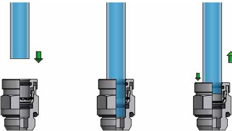
**!** Effettuato il collegamento, assicurarsi che il tubo inserito nel raccordo non sia sottoposto ad alcuna forza di trazione; è necessario inoltre rispettare durante il collegamento del tubo il raggio minimo di curvatura consigliato così come riportato nella sezione tubi di questo catalogo tecnico (vedi pag. 337).
