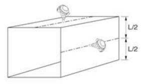
Abb. 3 Quadratischer Querschnitt, mittig auf der Leitung oder seitlich
