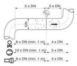
Abb. 1 Empfohlene Distanzen zu Ventilen, etc. (DN = nominaler Durchmesser)
