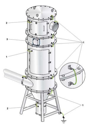
Entstaubungsgerät mit vorbeugendem Explosionsschutz
